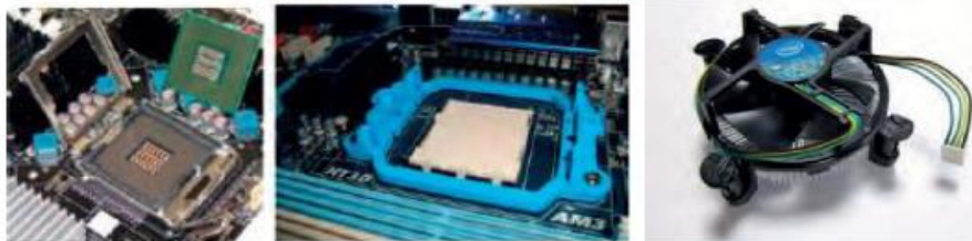
Εικόνα 3.5. (α) Socket επεξεργαστών της Intel, (β) Socket επεξεργαστών της AMD (γ) Ψύκτρα Επεξεργαστή
