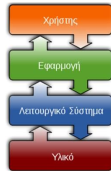
Εικόνα 19 Το Λειτουργικό Σύστημα μεσολαβεί μεταξύ εφαρμογών και υλικού
