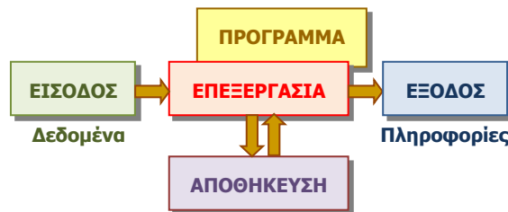
Εικόνα 16 – Βασικές λειτουργίες ενός Ηλεκτρονικού Υπολογιστή
