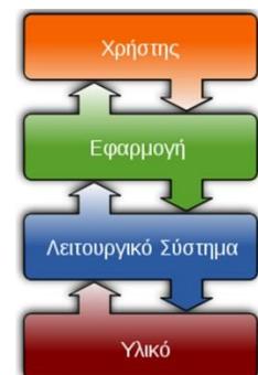
Εικόνα 24 Το Λειτουργικό Σύστημα μεσολαβεί μεταξύ εφαρμογών και υλικού
