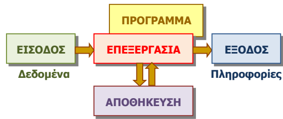
Εικόνα 2 – Βασικές λειτουργίες ενός Ηλεκτρονικού Υπολογιστή
