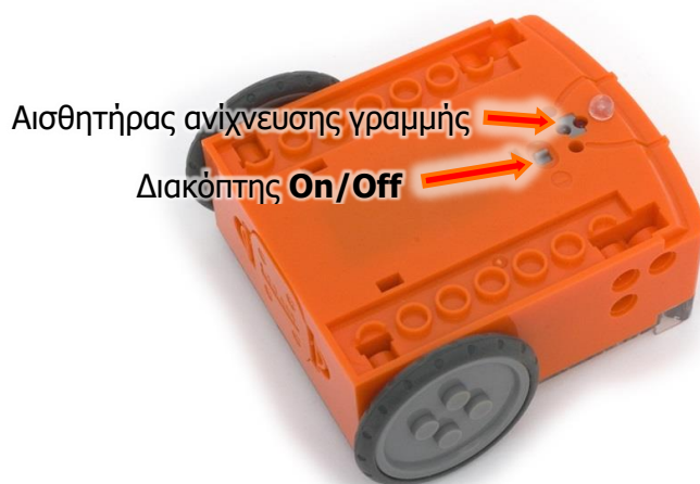
Ο διακόπτης On/Off και ο αισθητήρας ανίχνευσης γραμμής
